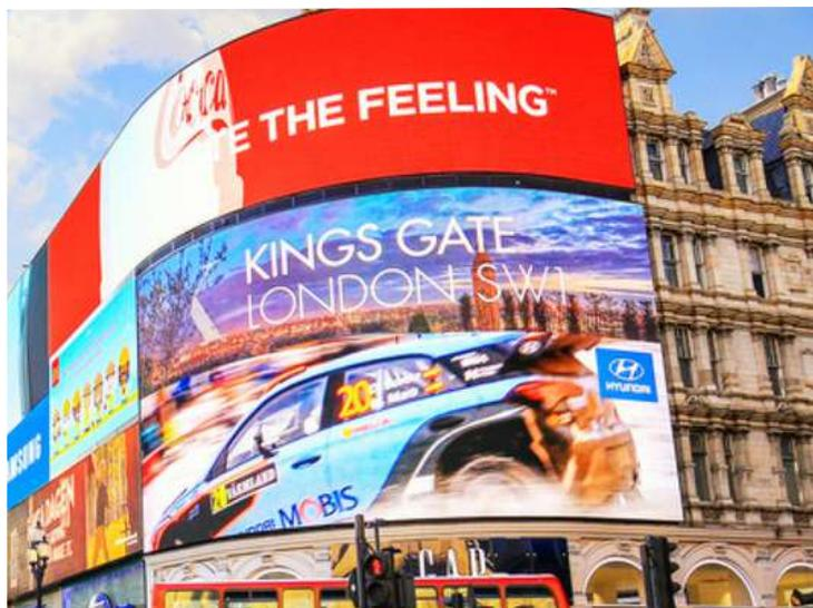
Questo tipo di installazione permette di sfruttare pareti angolari di interi edifici o del singolo punto vendita e può essere effettuata in due modi: attraverso schermi curvi (p...) o con la coordinazione di due display led fissi.
